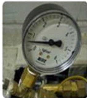
Тест на внутреннее давление отопительной трубы Daewoo
